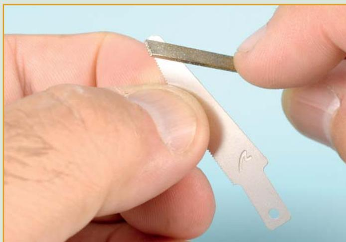
**4** С этой посылкой вы получили два инструмента — зубчатые лезвия, которые вам очень помогут при работе над моделью. Аккуратно вырежьте их из пластины-заготовки и надфилем зачистите края от остатков перемычек.
