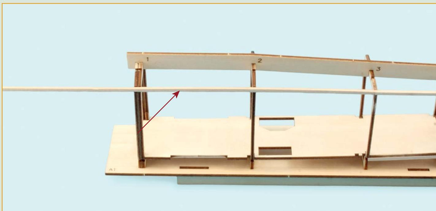
**10** Теперь возьмите еще одну рейку и вклейте ее в верхние пазы передних шпангоутов, как показано на снимке. На третьем шпангоуте склейте ее встык с задней частью лонжерона.
