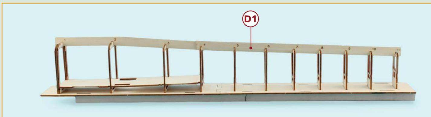
**7** Установите зажим-фиксатор D1 на задние фюзеляжные шпангоуты, как показано на снимке, **но не приклеивайте его**. Эта вспомогательная деталь нужна для удержания шпангоутов в вертикальном положении при окончательной сборке фюзеляжа. В дальнейшем она будет удалена.
