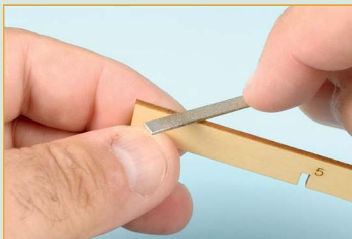
**6** Приступаем к сборке очередного узла модели «Илья Муромец». С помощью ножа аккуратно извлеките деревянные детали фюзеляжа из пластины-заготовки, как вы это уже делали, а затем надфилем и наждачной бумагой зачистите кромки для получения ровных и гладких поверхностей.
