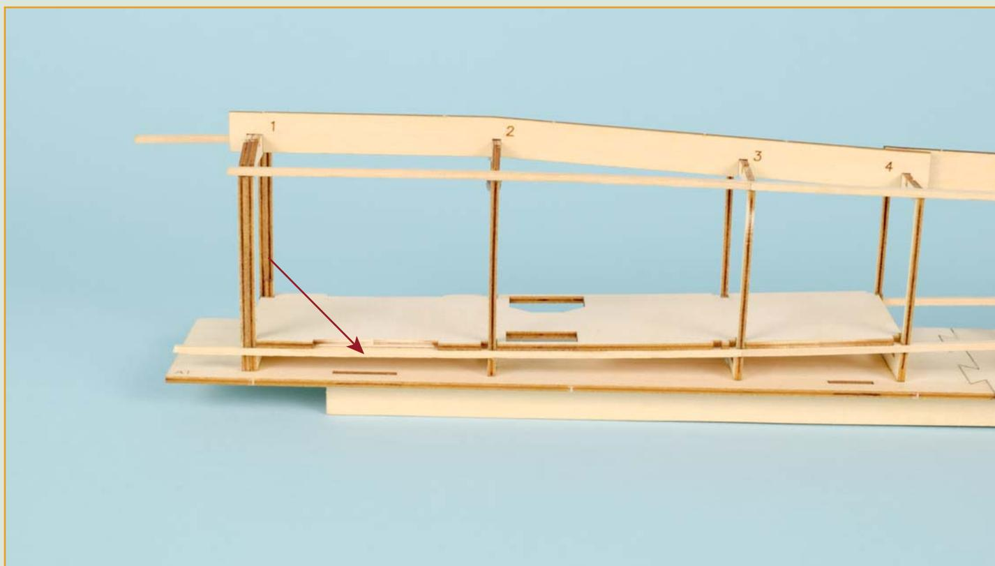
**12** Используйте отрезанный конец верхней рейки, чтобы закончить нижний лонжерон.
