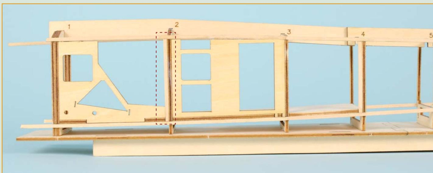
**15** Разметьте и отпилите два отрезка от рейки (2x2 мм), длина которых должна соответствовать высоте фюзеляжа между шпангоутами 2 и 4. Затем приклейте их к лонжеронам, шпангоутам и к полу.
