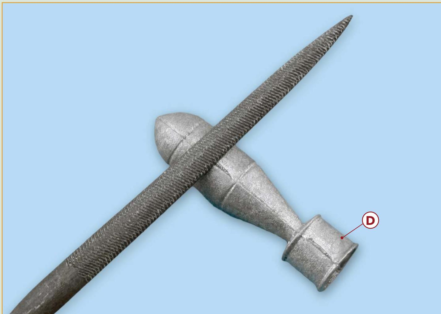
**22** Переходим к обработке бомб. Для начала зачистите их надфилем от следов литевых форм и обработайте наждаком для удаления неровностей и шероховатостей. Затем протрите тампоном или салфеткой, пропитанной спиртом или водно-спиртовым раствором, для лучшего сцепления краски с металлом.
