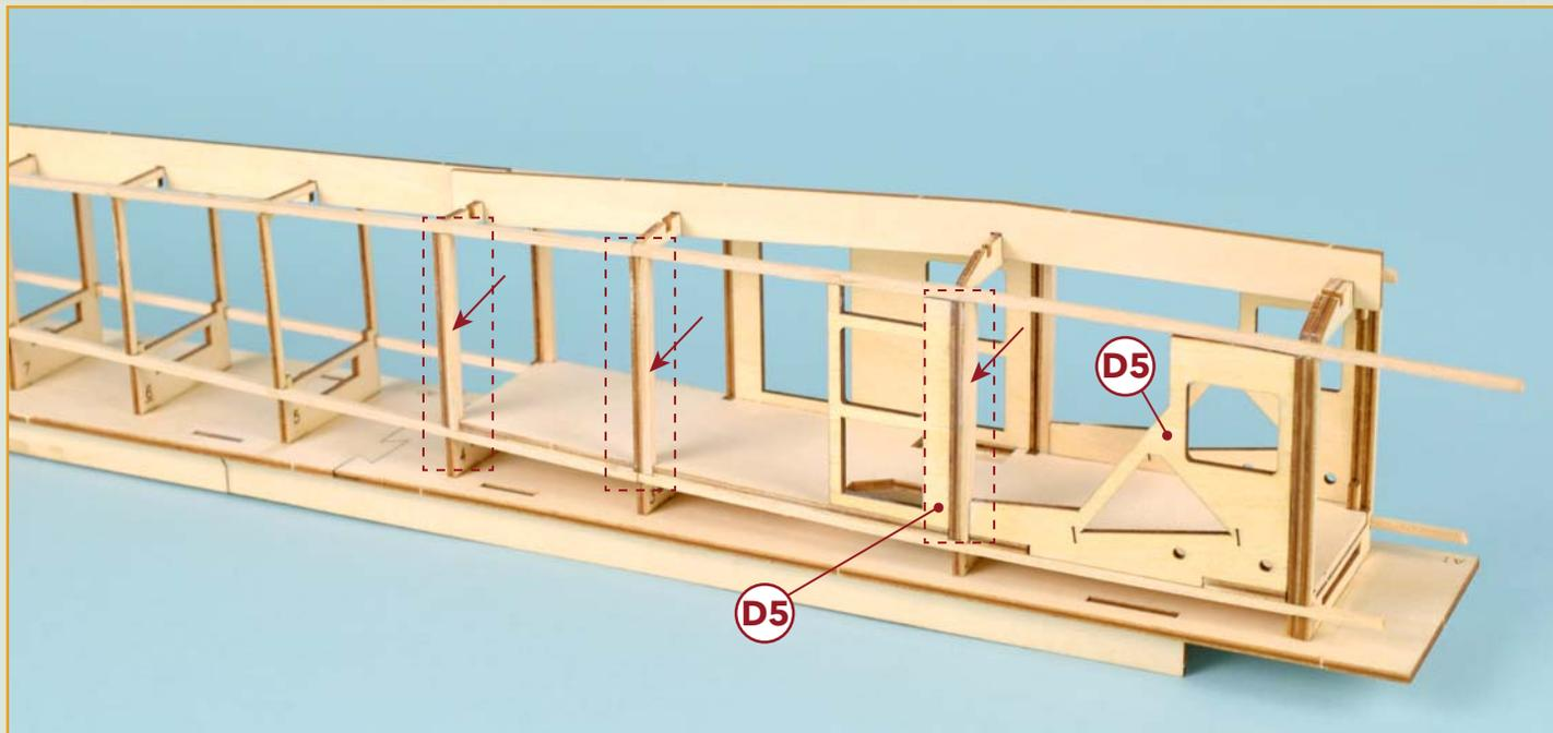
**16** На противоположной стороне фюзеляжа приклейте боковые стенки D4 и D5, как показано на снимке. **Обратите особое внимание на расположения детали D5.** Затем отпилите еще три отрезка рейки и приклейте их к шпангоутам 2, 3 и 4 встык с лонжеронами, ориентируясь по стрелкам на снимке. Нижние концы реек должны войти в предназначенные для них вырезы в полу кабины.
