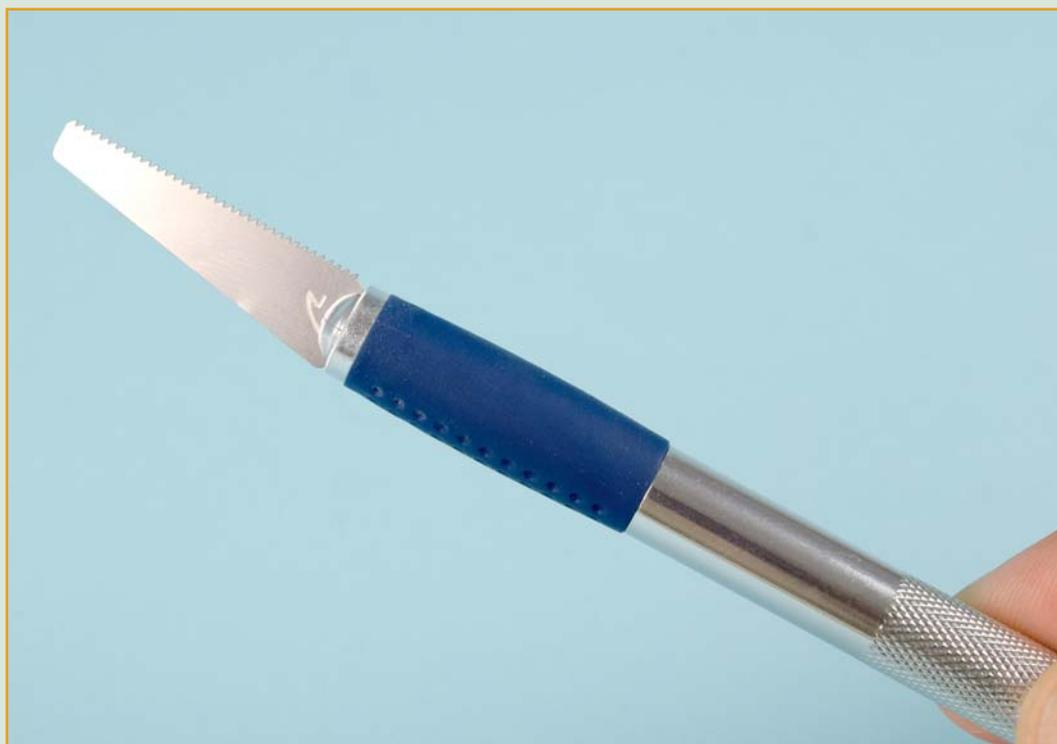
**5** Укрепив одно из лезвий в цанговом зажиме, вы получите миниатюрную пилку для тонких работ по дереву или пластмассе. Лезвие с крупными зубьями лучше использовать для древесины, а с более мелкими зубьями — для пластика.
