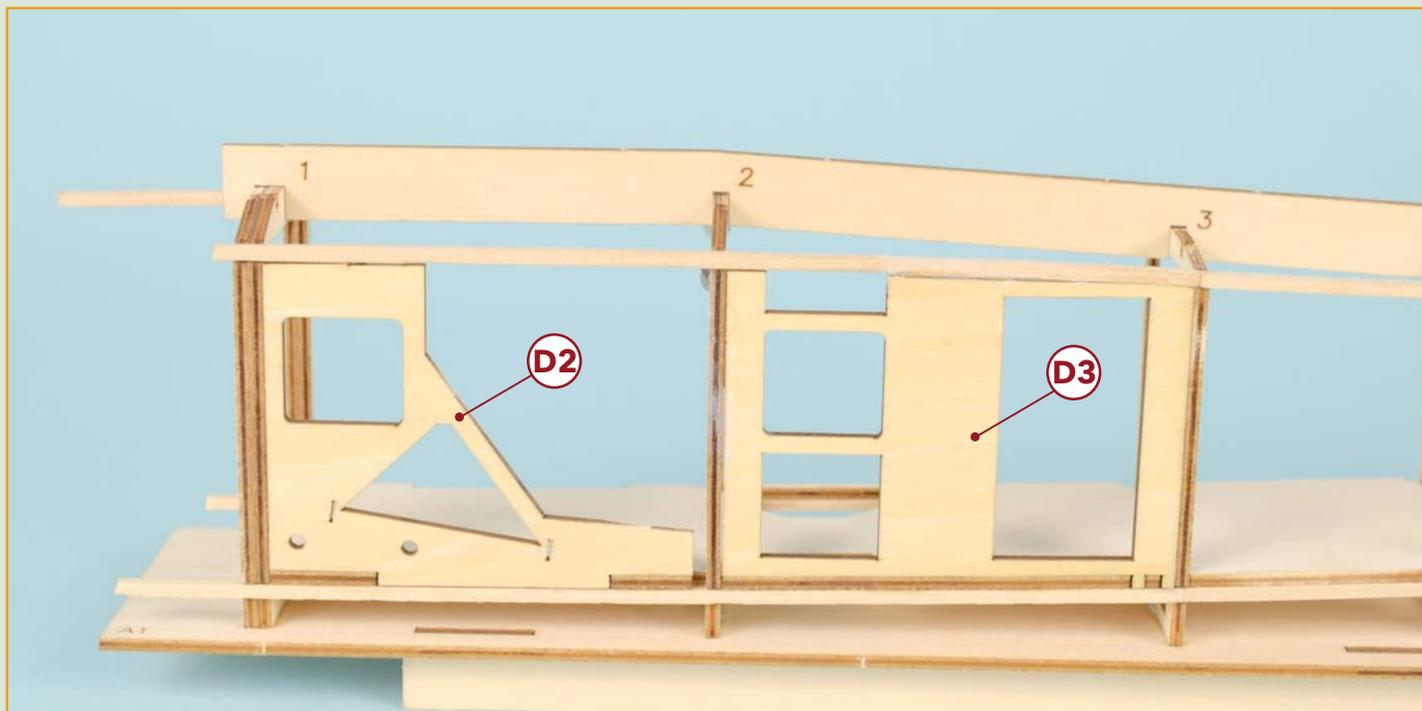
**14** Приступаем к сборке кабины. Вклейте на нужное место боковые стенки кабины D2 и D3, как показано на снимке. Стенки должны плотно примыкать к шпангоутам, лонжеронам и полу. При необходимости дополнительно обработайте внешние кромки стенок надфилем для лучшей подгонки.
