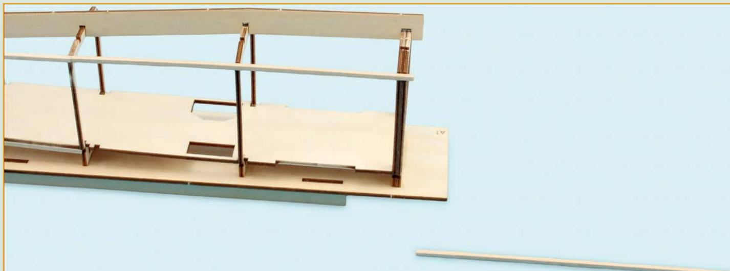
**13** Повторите те же операции с лонжеронами на другой стороне фюзеляжа.
